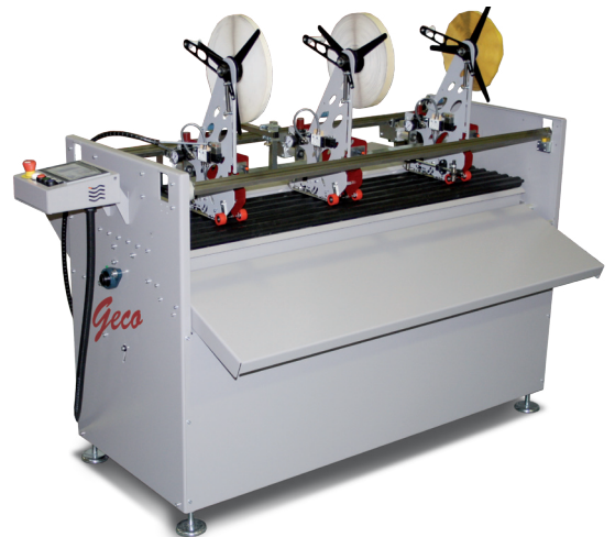
GECO 160 Duże, półautomatyczne urządzenie do nakładania dwustronnej taśmy klejącej, kleju itp.
