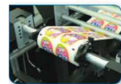
System odwijający Bardzo łatwy montaż roli (maks. szerokość wstęgi 350 mm / średnica roli 400 mm)
