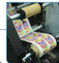
System nawijający Automatycznie nawija etykiety na rolę (maks. szerokość wstęgi 350 mm / średnica roli 400 mm)
