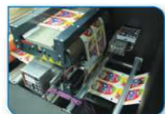
Czujnik prowadzenia wstęgi, kamera (opcjonalnie) Na bieżąco kontrolują bieg podłoża i korygują jego ścieżkę
