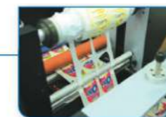
Usuwanie ażuru Oczyszcza etykiety z niezadrukowanego naddatku
